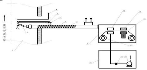
1-排气筒, 2-前弯管及采样嘴, 3-皮托管, 4-温度测量, 5-静压测量, 6-差压测量, 7-采样管, 8-加热保温套管, 9-分析测量装置, 10-射线源, 11-光电倍增管, 12-滤膜压紧装置, 13-滤膜传送控制装置, 14-抽气装置, 15-流量计, 16-抽气泵。
